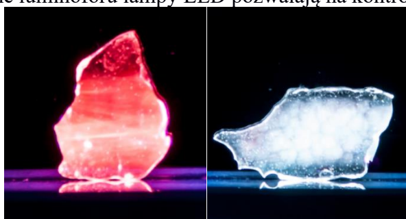
Rysunek 2: Przykłady fotoluminescencji materiałów szklanych domieszkowanych metalami rzadkimi [1].
